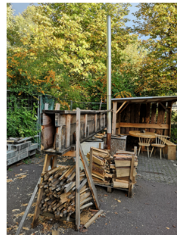
In diesem Ofen werden die Planken zunächst ‚gekocht‘, bevor sie dann am Schiffskörper gebogen montiert werden.
