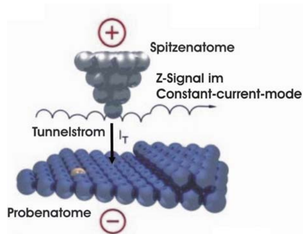
Abbildung 1.1: Schematische Darstellung der STM-Spitze mit dem Spitzenapex, der aus den letzten Atomen an der Spitze gebildet wird, sowie einer Probenoberfläche mit einer Stufenkante und einem Fremdatom.
